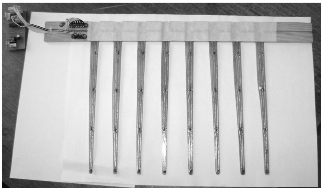
Рис. 1. Адаптер для съёма температурной информации в улье
