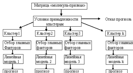
Рис. 1. Схема построения дерева решений ( k — число кластеров).
