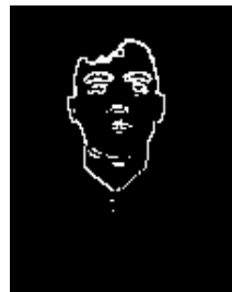
Рис. 2. Выделение границ объекта оператором Собеля
