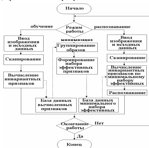
Рис. 1. Схема распознающей системы данного класса.
