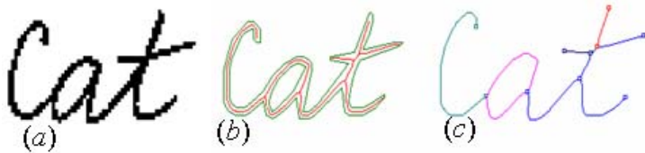
Рис.2. Скелетная векторизация при сегментации рукописного текста (a) исходное ДБИ, полученное в результате сканирования; (b) многоугольная фигура и скелетное представление; (c) выделение штрихов на основе анализа скелета.
