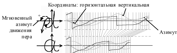
Рис. 1. Два сигнала в виде функций координат и азимута движения пера от пройденного пути вдоль его траектории, полученные при вводе рукописных символов в компьютер непосредственно в процессе написания.
