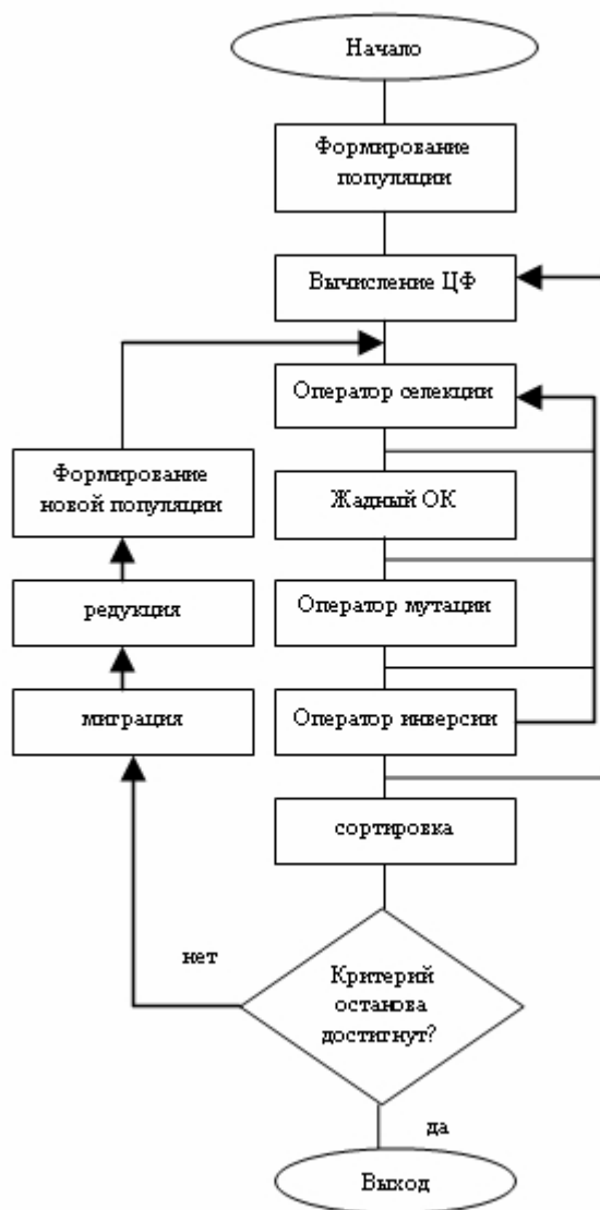
Рис. 1. Структура генетического алгоритма для решения задачи о нахождении кратчайшего пути в графе
