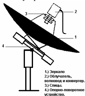
Рис.1. Основные элементы параболической антенны.
